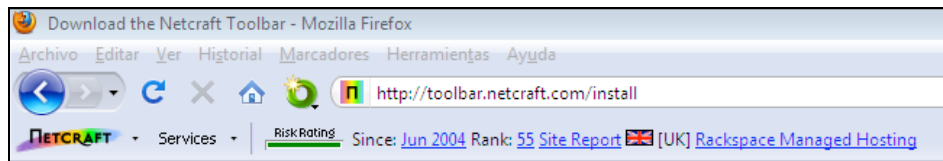
Imagen 4. Barra de herramientas Netcraft evaluando el riesgo del sitio. Cuando la línea se encuentra en rojo se indica un riesgo alto de fraude.
